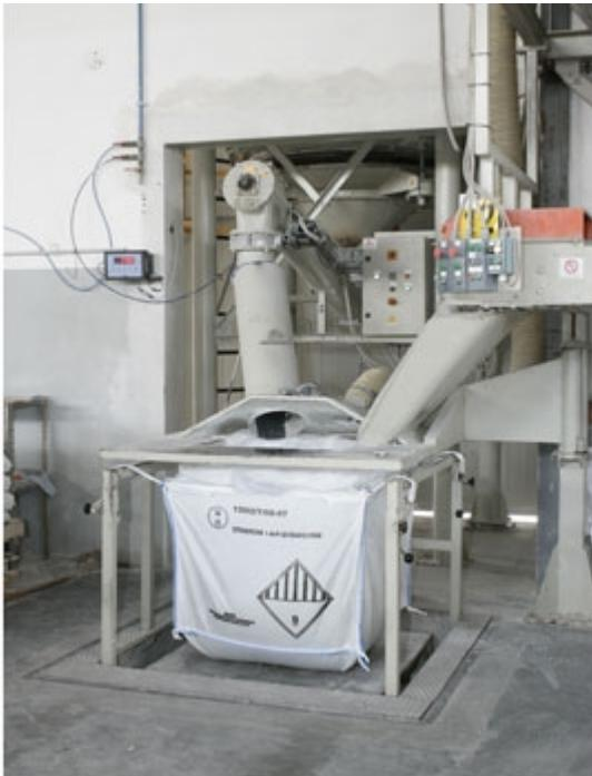
Esempi di installazioni e macchine per riempimento big-bag
